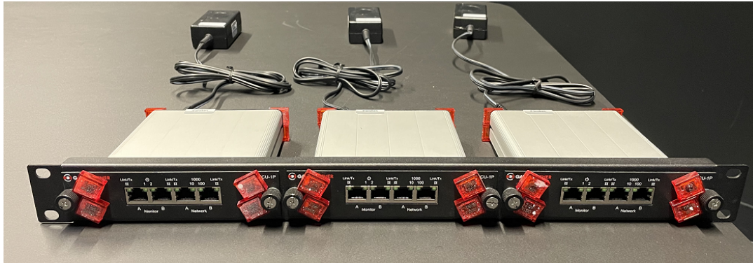
Figure5: Rack de trois GTap
